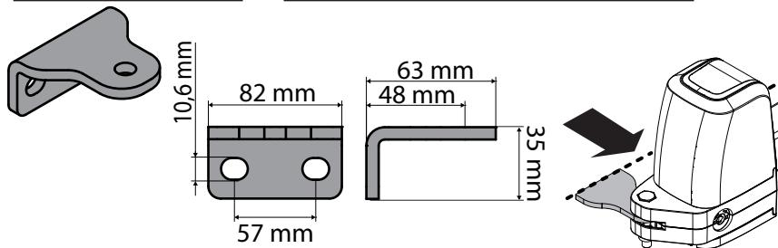
FISSAGGIO OPERATORE SULL'ANTA - OPERATOR ATTACHMENT ON DOOR - FIXATION DE L'ACTIONNEUR SUR LE VANTAIL
