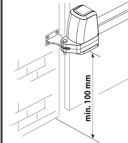
**FISSAGGIO MOTORE SU ANCORAGGIO A PILASTRO
