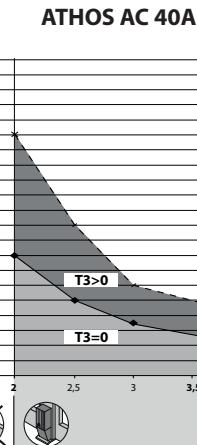
\*\* In caso di alimentazione a 60Hz il peso massimo dell'anta extrapolato dal grafico "Lunghezza"vs"Peso" va ridotto moltiplicandolo per coefficiente k=0.7
