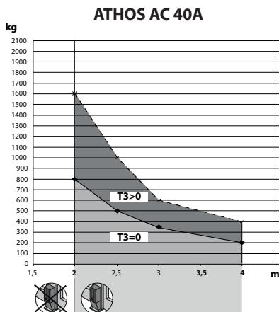
\*\* W przypadku zasilania napięciem o częstotliwości 60Hz, maksymalny ciężar skrzydła ekstrapolowany z wykresu zależności "Długości" od "Ciężaru" zostaje zmniejszony poprzez przemnożenie go przez współczynnik k=0,7
