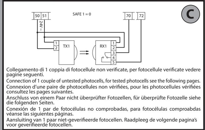
Collegamento di 1 coppia di fotocellule non verificate, per fotocellule verificate vedere pagine seguenti.
